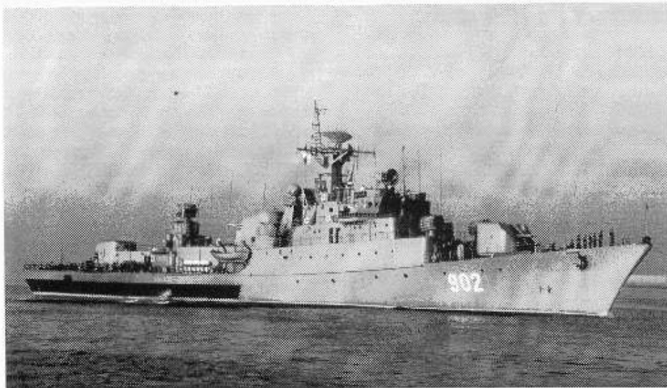
Fotografia de la FF Rais Kelic 902, un dels vaixells més importants de la marina argelina d'avui dia. Cal observar la franja negra a bona part de l'amura d'estribord, característica de les construccions russes.
